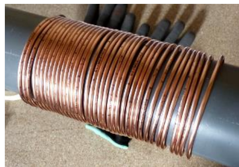
Spule auf PVC Rohr wickeln
