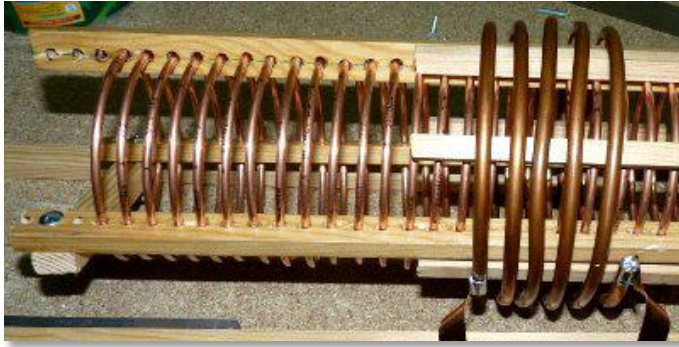
Sekundärspule drüber gewickelt
