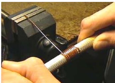
Spulendraht ziehen & wickeln
